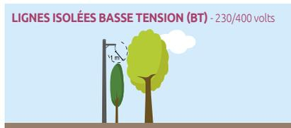
*Enedis demande que l'élagage soit réalisé en augmentant d'au moins un mètre les distances prévues à la construction des lignes.*
